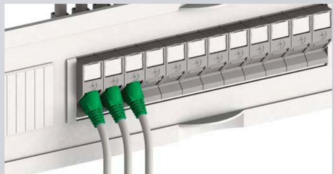
Höhe des TS45 und des Elektroverteilers sind optimal aufeinander abgestimmt: Das AMJ-S Modul ist so eingebaut, dass der Entriegelungshebel des Patchkabels von oben bedienbar ist.
