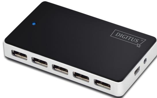
**USB 2.0 Hub 10-Port, 10xUSB A/F, 1x USB mini incl. ext. Netzteil 5V DC 4A, 1m, sw**
