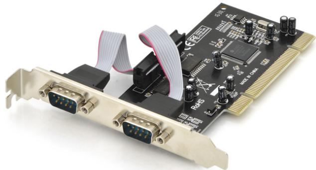
**Serial I/O RS232 PCI Add-On Card 2-port, Chipsatz: MCS9865**
